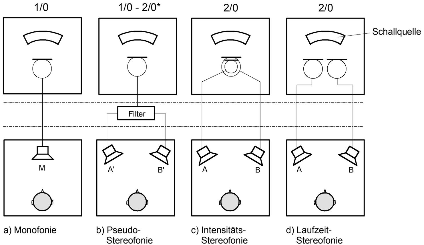
**Schematische Darstellung der Übertragungsverfahren der Zweikanalstereofonie**
